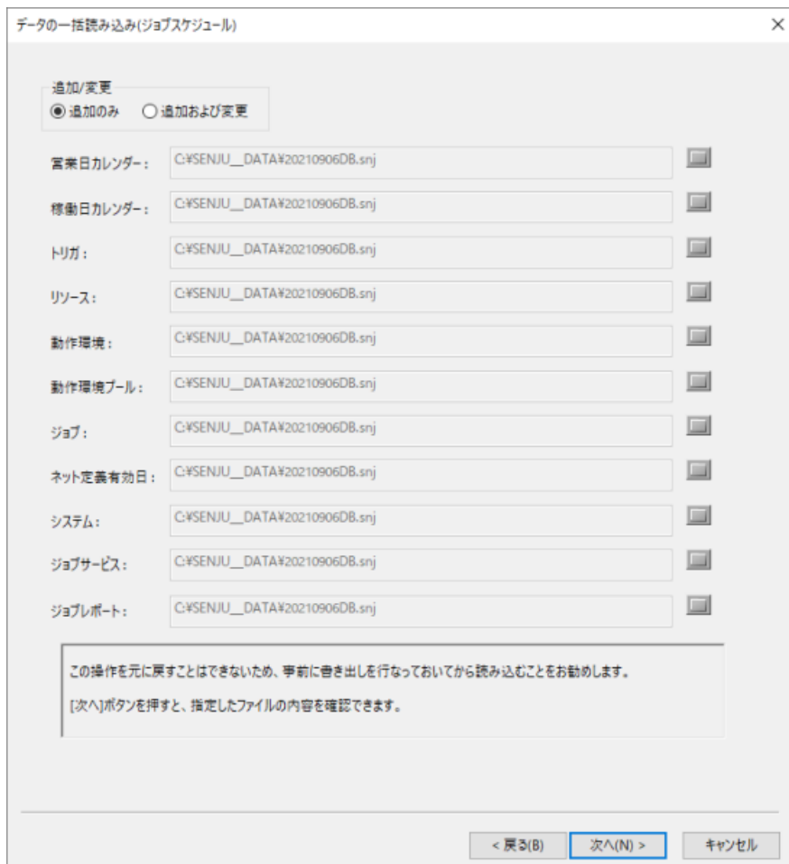
図 4.16 データの一括読み込みダイアログ(テキスト読み込み)
