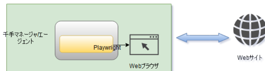
図 5.2 Web監視(外形監視)の概要
