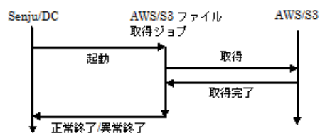
図 3.9 AWS/S3ファイル取得ジョブの処理の流れ
